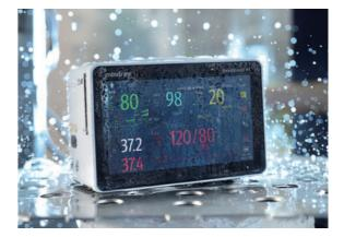
Le N1 affiche un indice de protection IP44 contre la poussière et les projections d'eau, et une résistance aux chutes de 1,2 m sur ses six surfaces, ce qui témoigne de sa conception robuste et élimine ainsi toute inquiétude quant aux dommages qu'il pourrait subir en cas d'éclaboussures et de chute accidentelles lors du transport.
