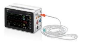
Le module CO<sub>2</sub> Sidestream entièrement intégré du N1 surveille l'état respiratoire des patients via la ligne d'échantillonnage connectée. Il est inutile d'ajouter des modules supplémentaires lors du transport de patients, en particulier ceux qui sont intubés.
